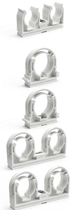
Крепления используются для фиксации трубопроводов из пласт-алюминия. Быстро и легко устанавливаются / демонтируются, не препятствуют возможности линейного расширения трубопровода. Производятся с креплением в виде овального отверстия без хомута. Изготовлены из полипропилена с термостойкостью до 90 °С.
